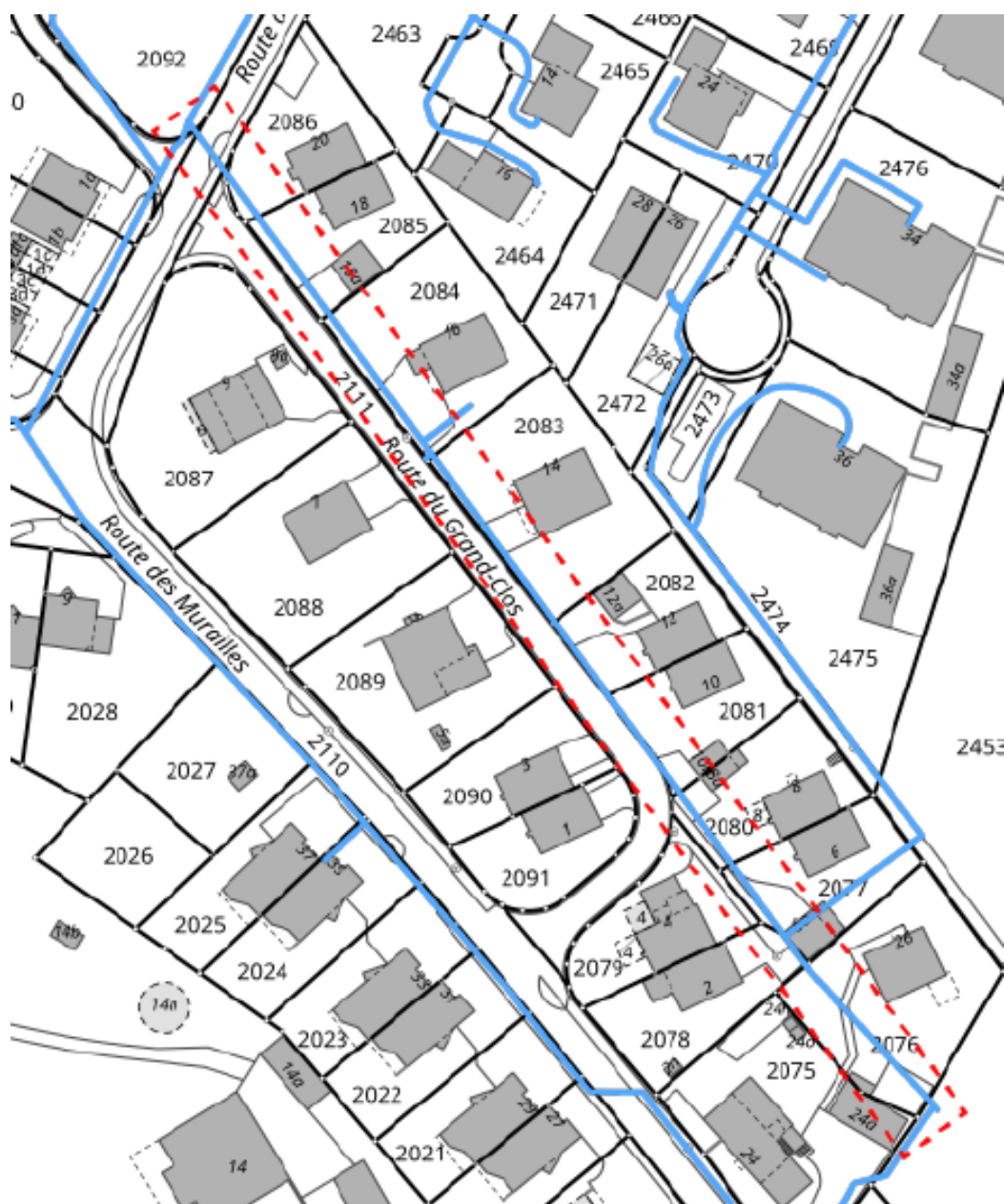
Figure 1 - Conduite d'adduction d'eau potable à renouveler
